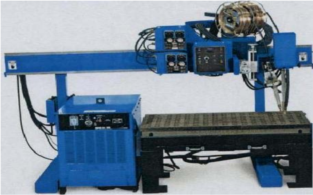
شكل رقم ( 2 ) يبين معدات اللحام بالقوس المغمور
